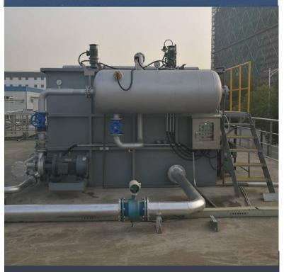
将化学反应与气浮结合于一体的装置。 化学混合反应器(机械混合反应或管道 混合反应)和气浮一体化的解决方案, 该系统更加集约,为用户节省更多占地。 将化学反应与气浮结合于一体的装宣。 化学混合反应器(机械混合反应或管道 混合反应)和气浮一体化的解决方案, 该系统更加集约,为用户节省更多占地。
